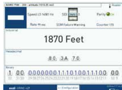
RX DETAILS Check all ARINC429 key parameters
