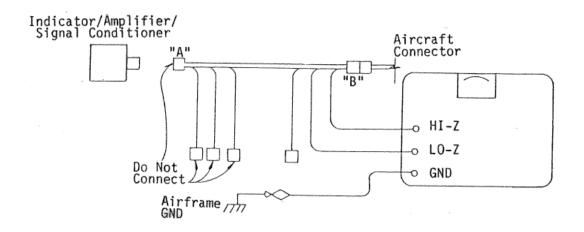
Figure 7 INSULATION TEST, CONFIGURATION #2
