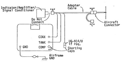
Figure 10 CONFIGURATION OF CAPACITANCE TEST
