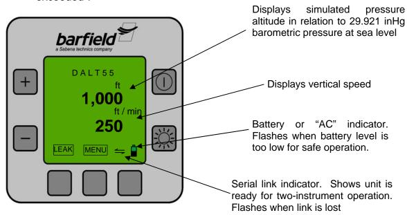
FIGURE 3 AERONAUTICAL DISPLAY
