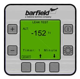
FIGURE 4 LEAK TEST TIMER DISPLAYS
