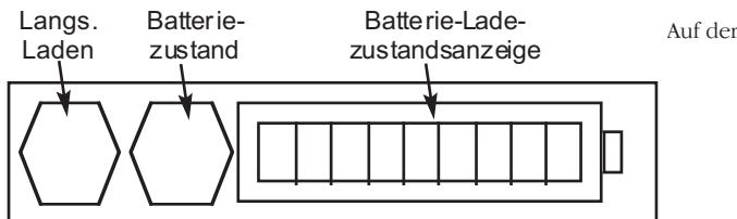
Vorderseite des Batteriemoduls befinden sich zwei Tasten und eine LED-Anzeige mit 10 Segmenten.
