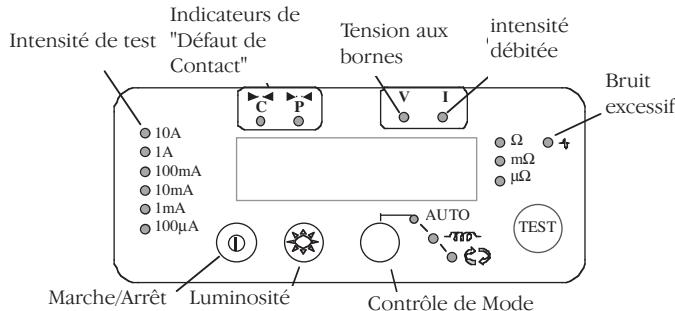
Appuyer sur le bouton Marche/Arrêt pour allumer le DLRO 10. Tous les témoins s'allument, les témoins V et I clignotent, puis la version du logiciel va s'afficher et le témoin W va s'allumer. Si les cordons d'essais n'ont pas été connectés à l'échantillon de test, les témoins 'C' et 'P' vont aussi être allumés. Appuyer de nouveau sur le bouton Marche/Arrêt pour éteindre l'instrument. Si l'instrument n'est pas utilisé pendant 5 minutes, il s'éteint automatiquement.
