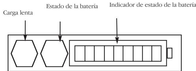
Para conocer la cantidad de carga en su módulo de batería, ya esté conectada a su DLRO o por separado, pulse el botón de estado de la batería. El indicador de estado de la batería encenderá entre 1 y 10 segmentos, lo que significa una carga del 10% y 100% respectivamente. Después de unos segundos, la pantalla se apagará automáticamente.
